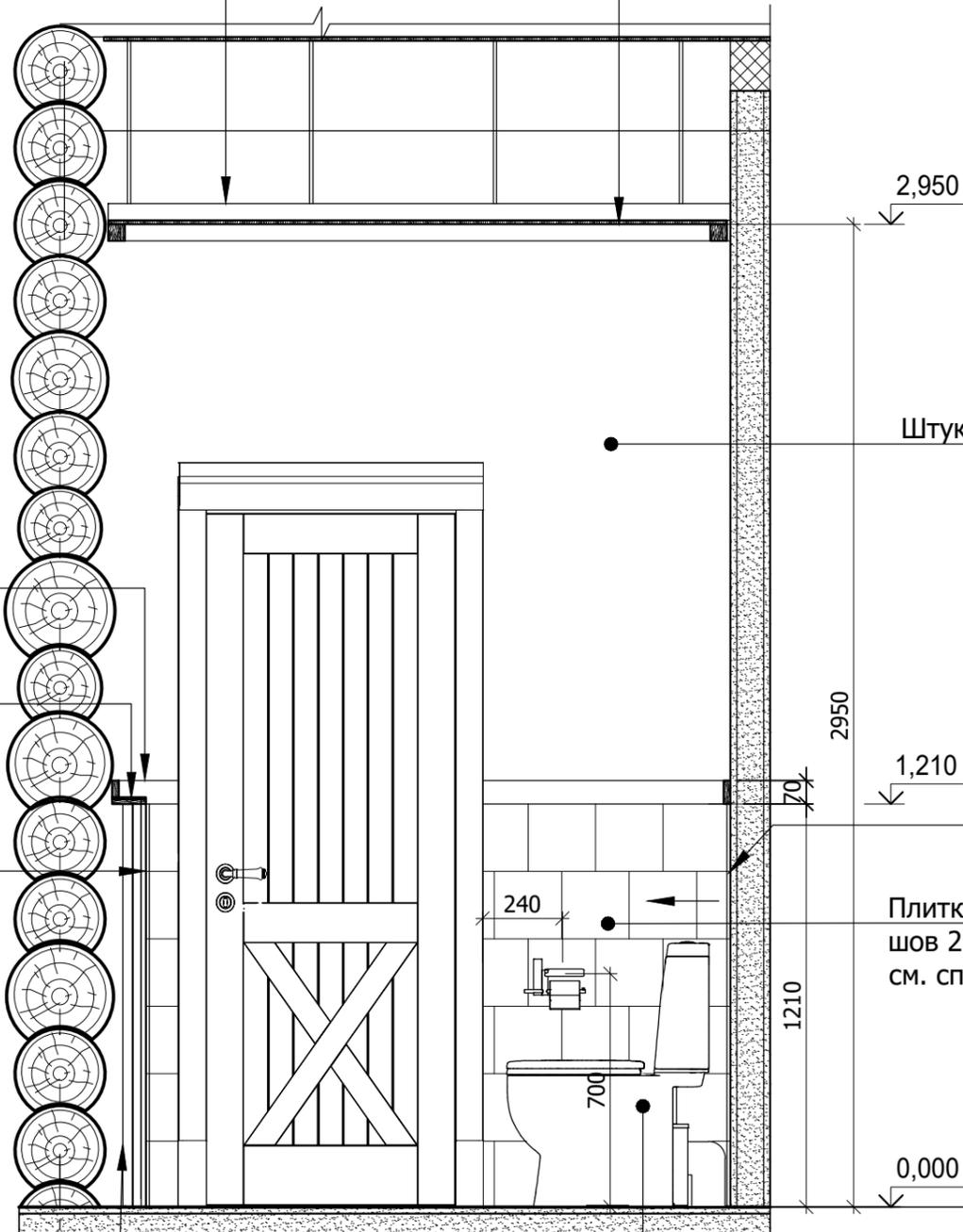
Каркас под плитку на скользящих креплениях, обеспечить вент. зазор между бревном и аквапанелью не менее 30 мм
