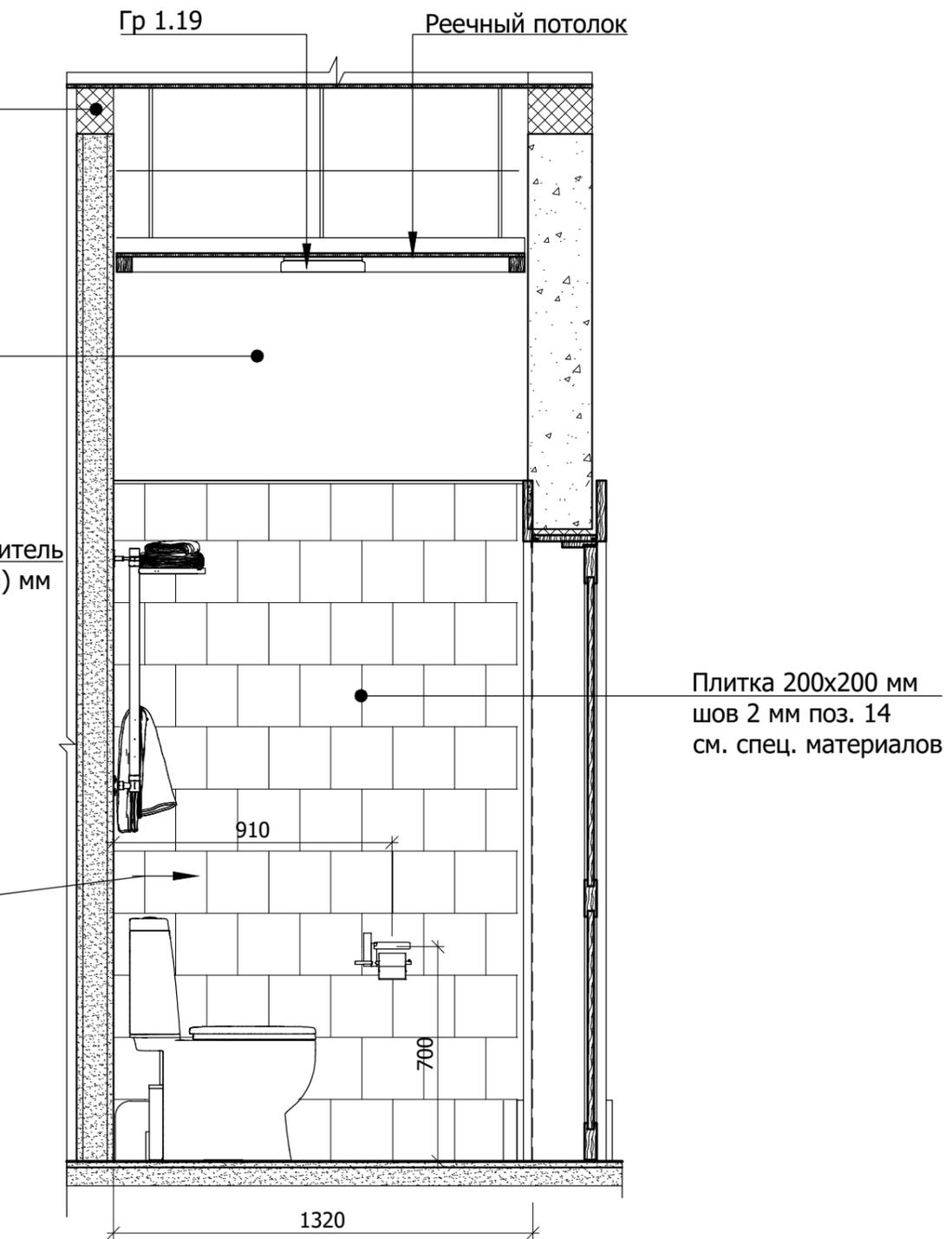
1. В зонах душевой кабины произвести гидроизоляцию стен
