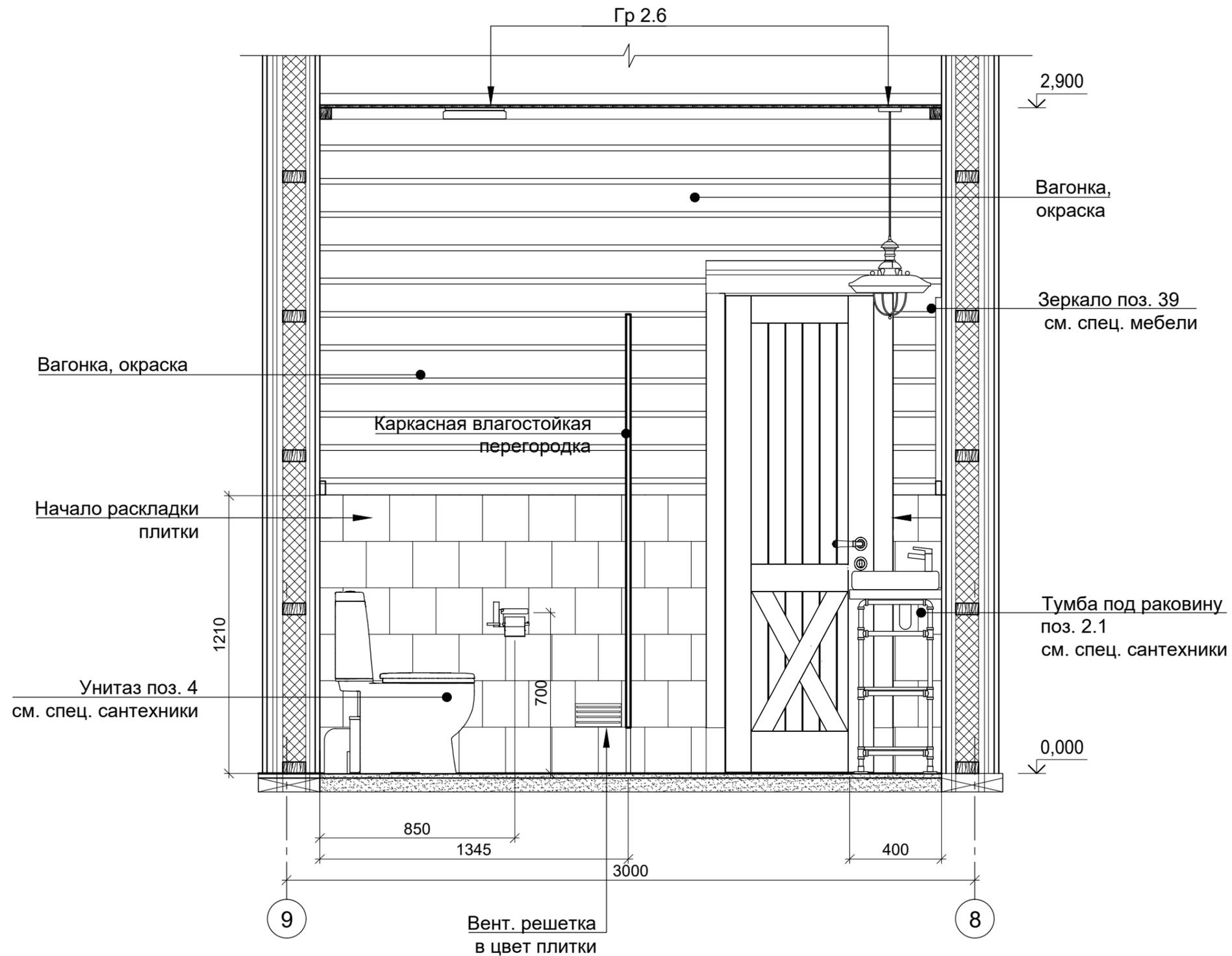
1. Производитель влагостойких перегородок обязан произвести обмеры перед производством
