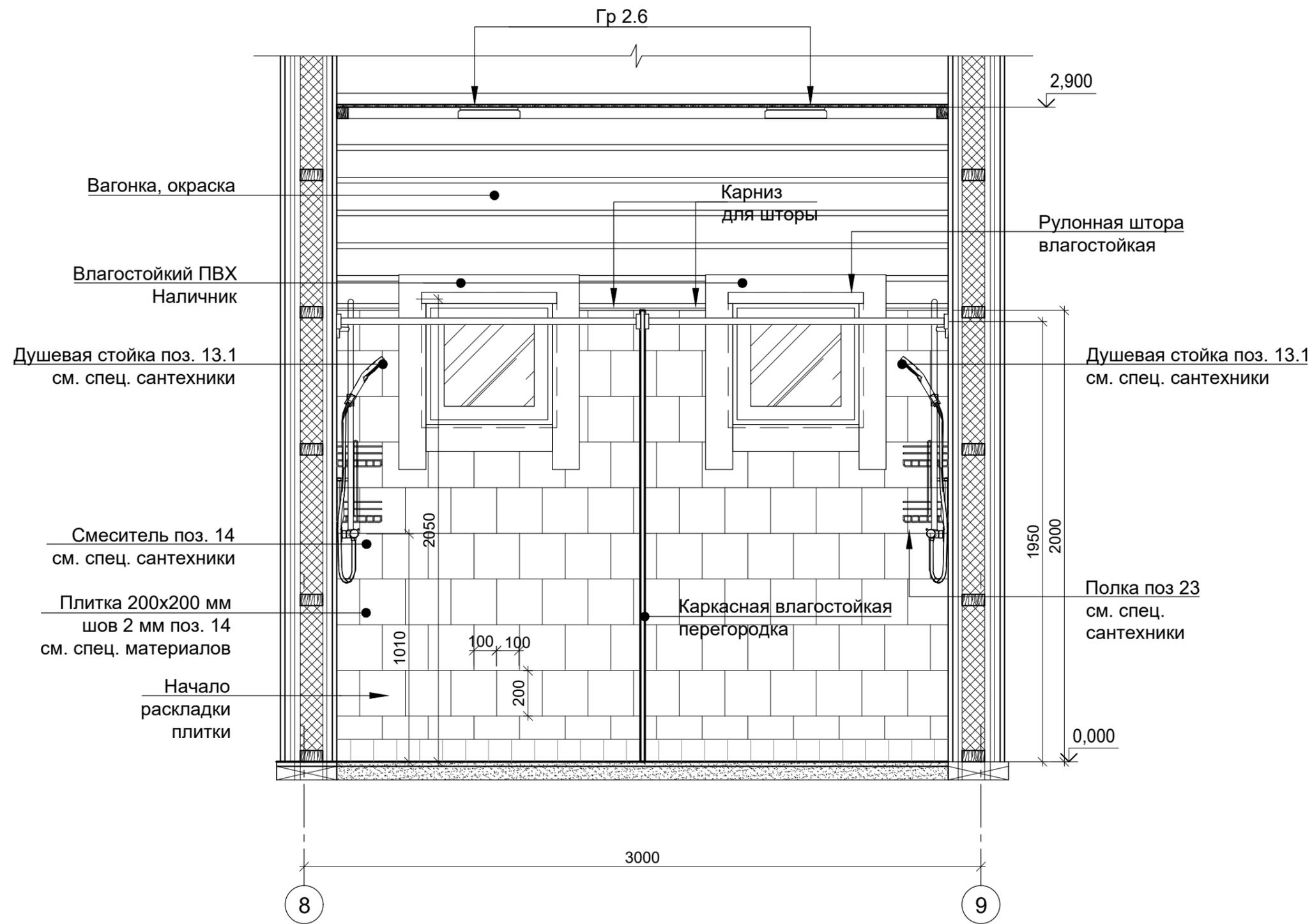
1. Производитель влагостойких перегородок обязан произвести обмеры перед производством
