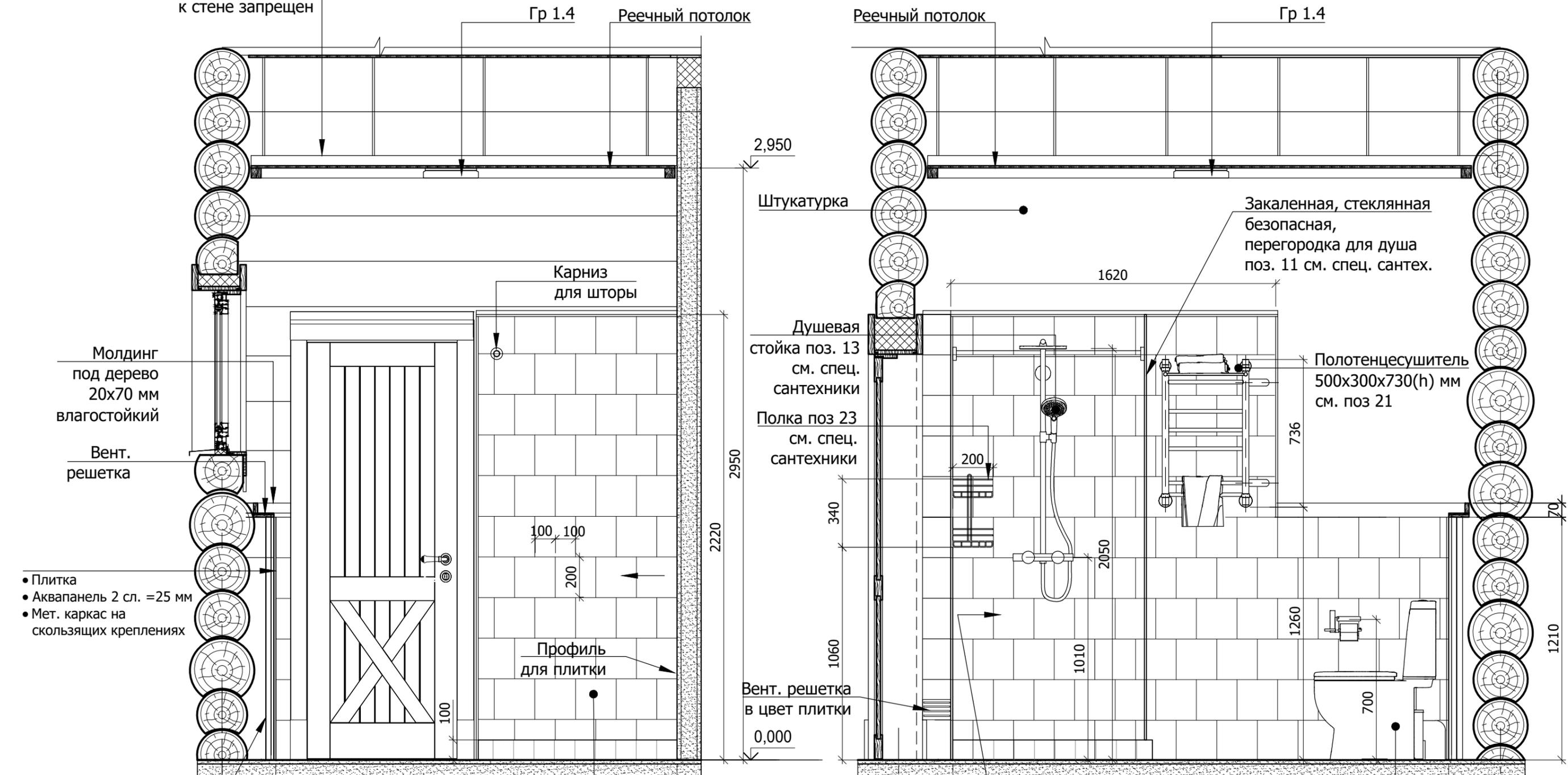
Каркас под плитку на скользящих креплениях, обеспечить вент. зазор между бревном и аквапанелью не менее 30 мм
