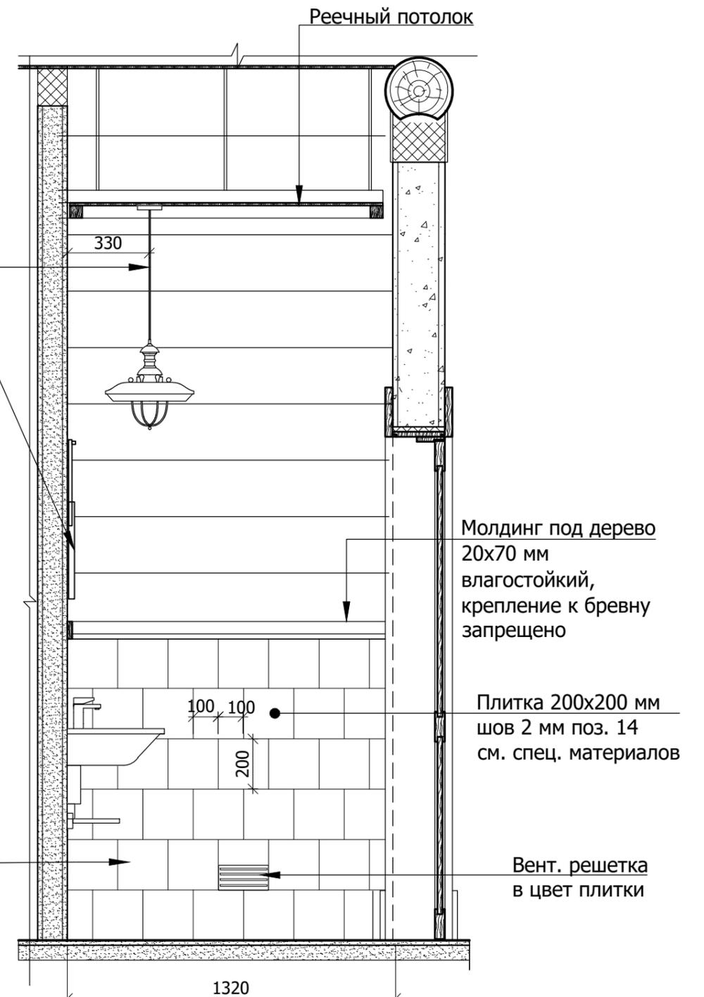
1. В зонах душевой кабины произвести гидроизоляцию стен
