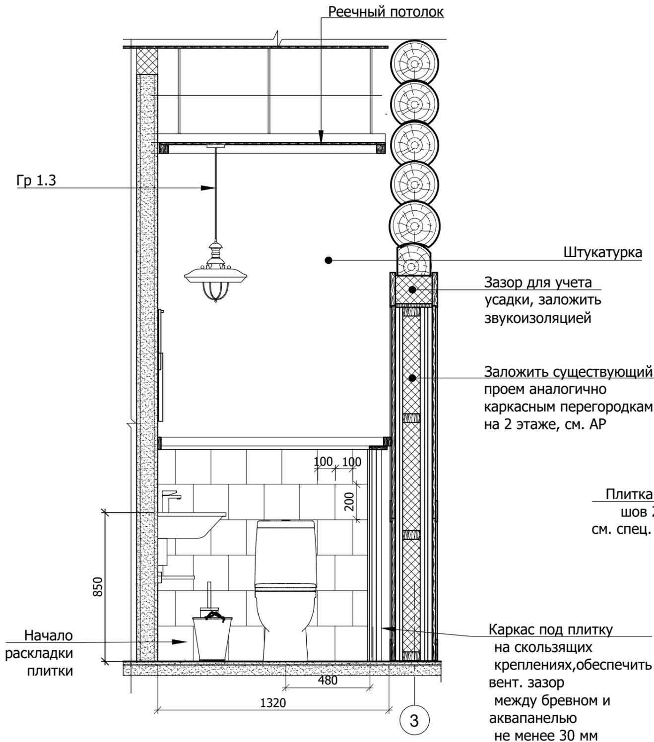
1. В зонах душевой кабины произвести гидроизоляцию стен
