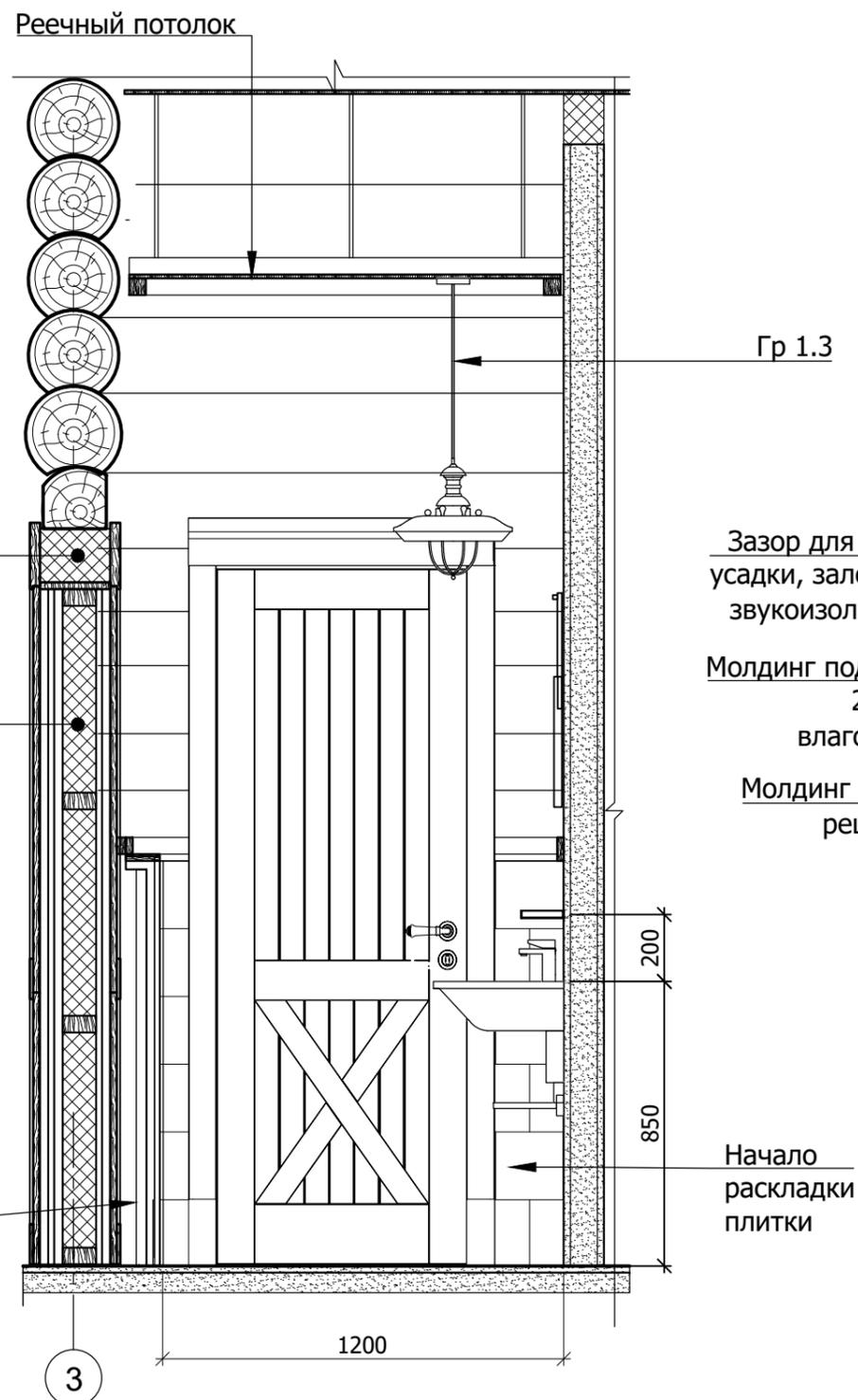
Зазор для учета усадки, заложить звукоизоляцией
