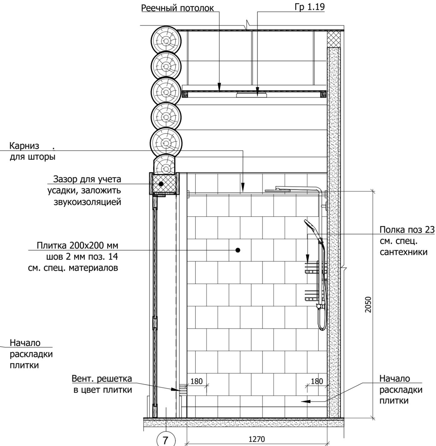
1. В зонах душевой кабины произвести гидроизоляцию стен
